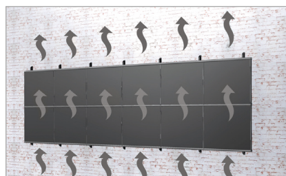
Mycket god ventilation på baksidan av modulerna
