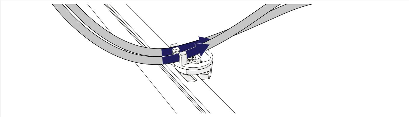
**3 SLIDE THE END CAPS ONTO THE RAILS.**
