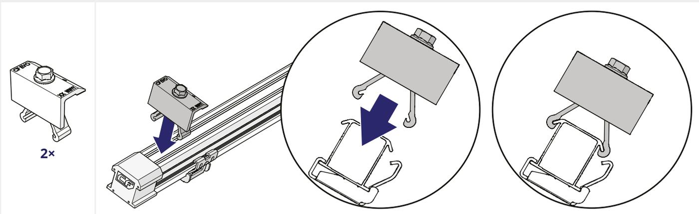
**5 PLACE THE PANEL ON THE RAILS AND SLIDE THE PANEL AGAINST THE END CLAMPS.**
